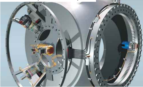
Blattlager mit Einleitungssystem und Sprühschmiersystem
