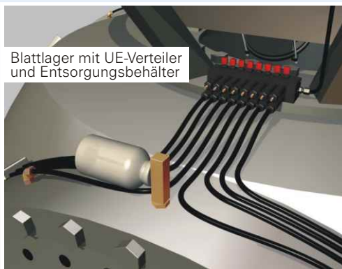
Blattlager mit Einleitungsschmiersystem
